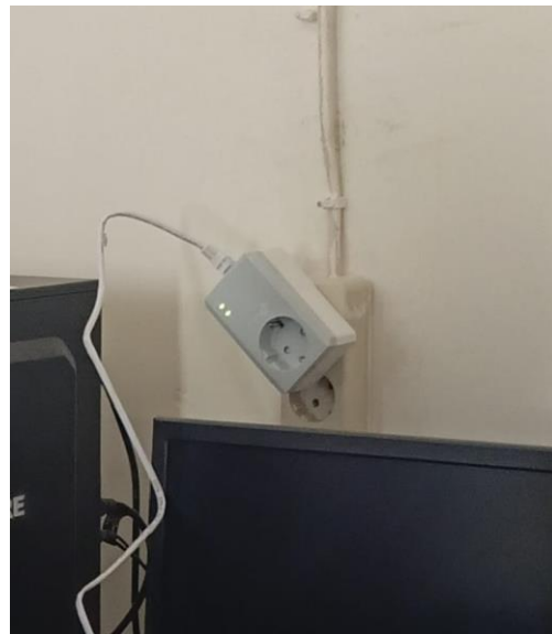
Gambar 14 PLC Penerima Pada Stok Kontak
