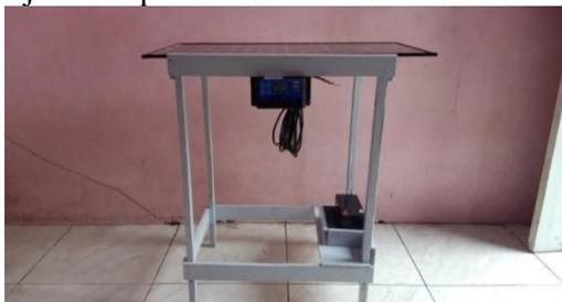
Gambar 25. Pemasangan sumber tegangan
