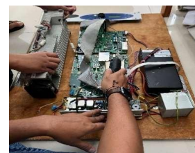
Gambar 6 Pengecekan DC Regylator pada mock up
