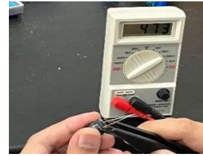
Gambar 10 Nilai kapasitor baru 470 \mu F
