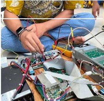
Gambar 8 Pengukuran nilai kapasitor
