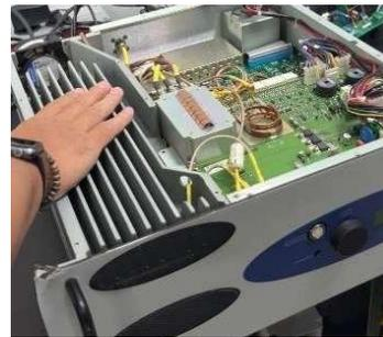
Gambar 16 Pengecekan menggunakan salah satu PA
