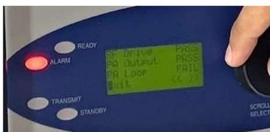
Gambar 17 Keterangan *PA LOOP fail*
