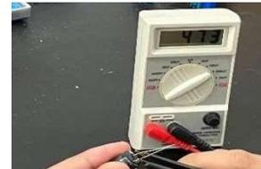
Gambar 10 Nilai kapasitor baru 470 $\mu\text{F}$
