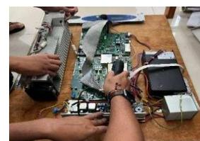
Gambar 6 Pengecekan DC Regulator pada mock up
