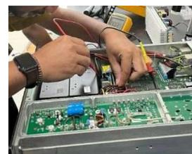
Gambar 3 Pengukuran tegangan
