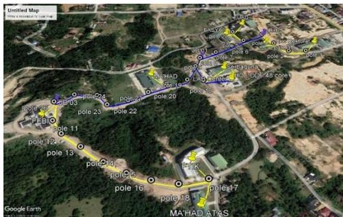
Gambar 4.2 Rencana Penarikan Kabel Fiber Optik Udara
