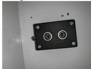
Gambar 7. Sensor Ultrasonik HC SR04 pada kandang
