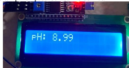
Gambar 8 Pengujian LCD 16x2
