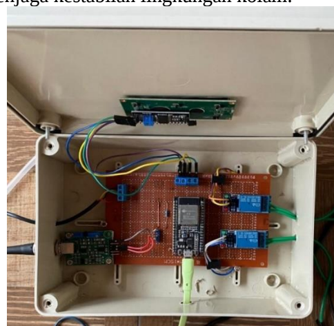
Gambar 6 Rangkaian Sistem Pemantau dan Pengendali Suhu dan pH
