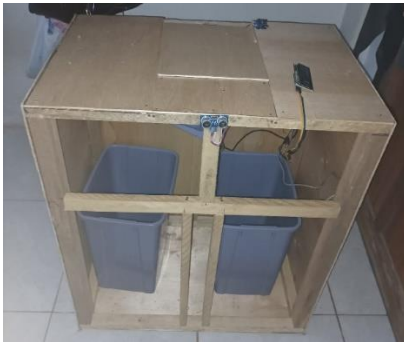
Gambar 18 Rancang Bangun Pemilah Sampah Logam dan Non-Logam Otomatis
