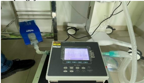
Gambar 1. prosedur pengukuran kalibrasi ventilator pihak ke dua
