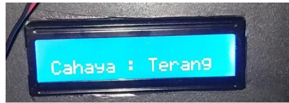
Gambar 4 : Tampilan LCD yang menunjukkan data dari sensor cahaya
