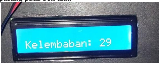
Gambar 3 : Tampilan LCD yang menunjukkan data dari sensor soil moisture
