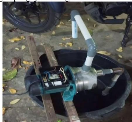
**Gambar 3** Pengujian Motor Pompa Air
