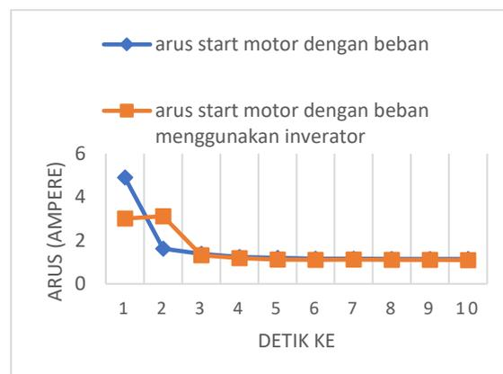
**Gambar 16** Perbandingan Pengujian Start Motor Dengan Beban
