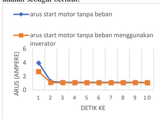
**Gambar 15** Perbandingan Pengujian Start Motor Tanpa Beban
