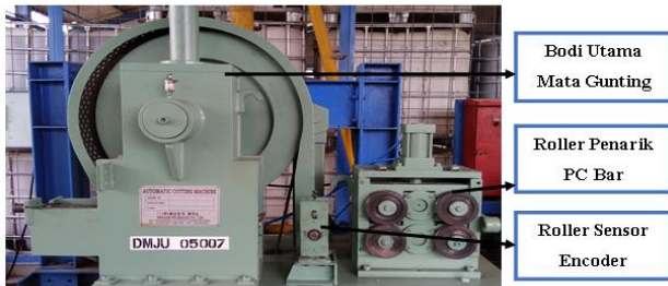
Gambar 4. Penempatan Roller Sensor Encoder
