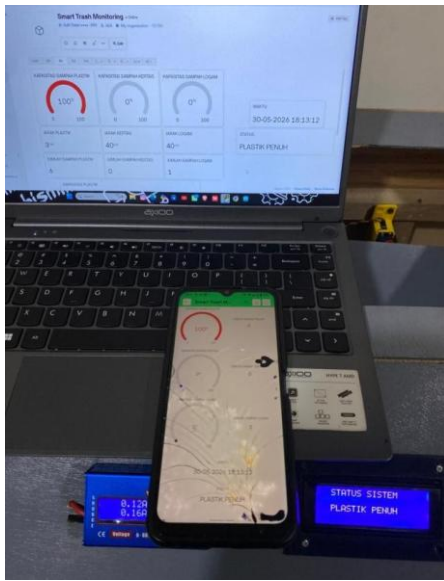
Gambar 10. Sinkronisasi Data Tampilan LCD dan Dashboard Blynk Saat Wadah Penuh
