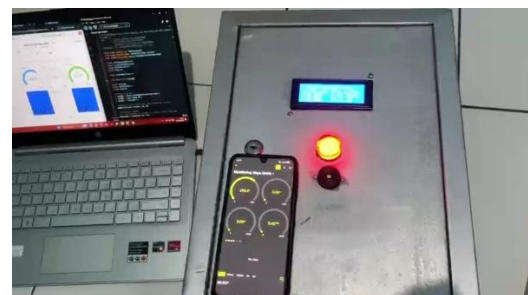
Gambar 9 Perograman sistem monitoring daya listrik pada alat pres produksi carica berbasis IoT
