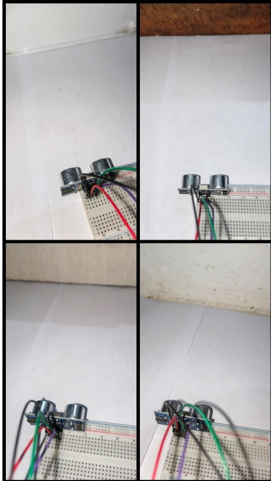
Gambar 8. Pengujian sensor HC-SR04
