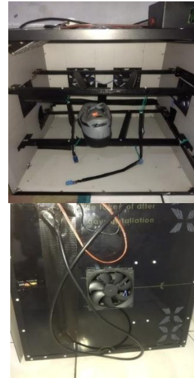
Gambar 5. Tampak Dalam dan Luar Prototipe Alat Pengering sepatu
