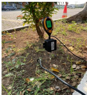
Gambar 10 Pengujian sensor pada tanah
