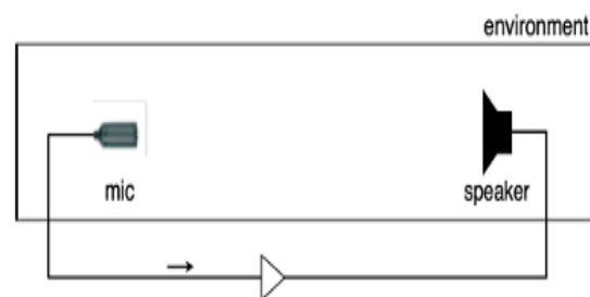
Gambar 1: Feedback Pada Sistem Audio
