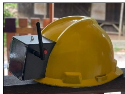
Gambar 4. Integrasi Perangkat pengirim pada Helm Safety
