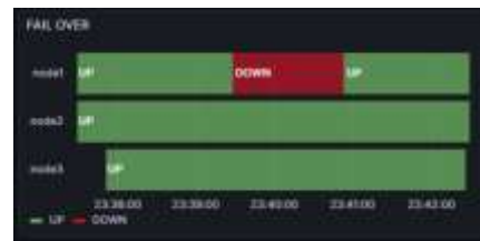
Gambar 12 Monitoring failover pada Grafana
