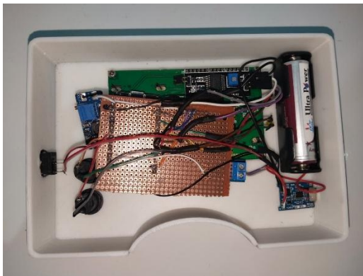
Gambar 3. Implementasi Perangkat Keras Scoliometer Digital
