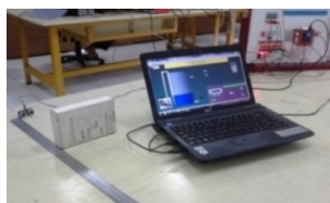
Gambar 14. Pengujian sensor ultrasonik menggunakan pengaris.
