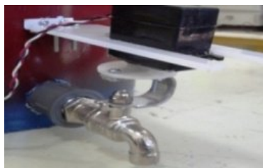
Gambar 19. Perangkat keras valve kondisi pada saat close.
