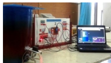
Gambar 7. Rancang bangun monitoring dan pengendalian level cairan
