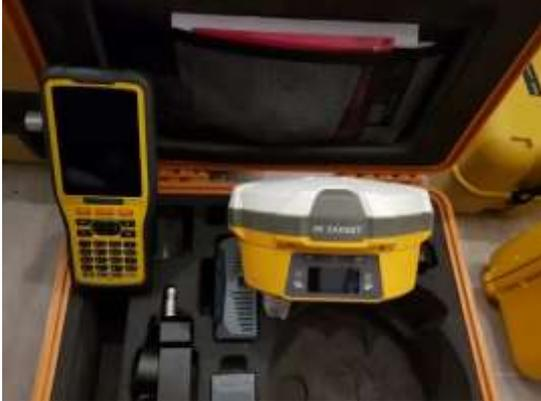
**Gambar 1.** Bentuk Fisik Peralatan GPS HI-Target V60
