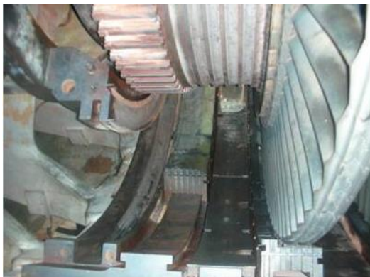
Gambar 5. Shroud dan nozzle (sudu tetap) yang akan diangkat
