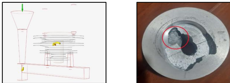
Gambar 6. Perbandingan porositas hasil simulasi dan aktual
