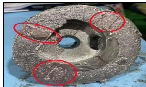
Gambar 11. Perbandingan cacat shift hasil simulasi dan aktual
