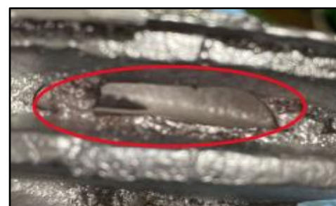
Gambar 12. Perbandingan cacat misrun hasil simulasi dan aktual
