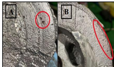
Gambar 9. Perbandingan gas defect hasil simulasi dan aktual
