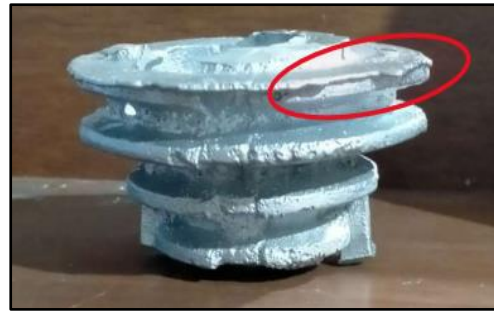
Gambar 10. Perbandingan cacat fin hasil simulasi dan aktual
