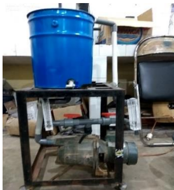
Gambar 2. Alat instalasi sistem quenching tersirkulasi
