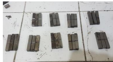
Gambar 3. Spesimen Baja AISI 1045 (spesimen uji impak)
