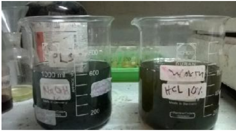
Gambar 5. Proses pengkorosifan dengan larutan HCl
