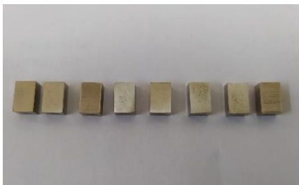
Gambar 1. Spesimen baja Hadfield
