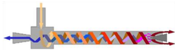
Gambar 1. Ilustrasi cara kerja tabung vortex[2].
