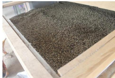
Gambar 6. Biji kopi beras yang dihamparkan di dalam ruangan pengering, berkapasitas 100 kg.
