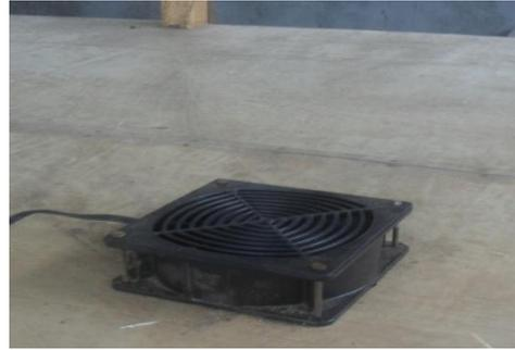
Gambar 4. Kipas untuk sirkulasi udara dari ruang pengering ke lingkungan
