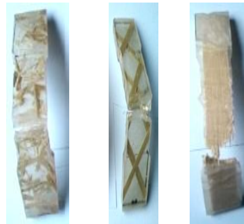
Gambar 4. Foto patahan spesimen uji tarik
