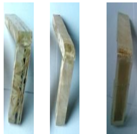
Gambar 5. Foto patahan spesimen uji bending
