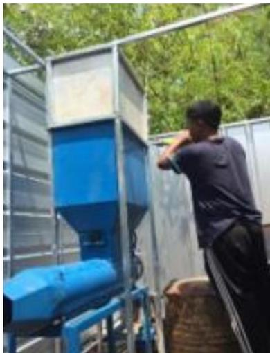
Gambar 2 mesin press jerami yang telah selesai dibuat
