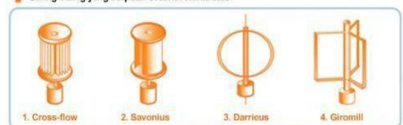
Gambar 2. Baling-baling yang berputar secara vertikal
