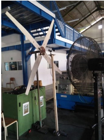
Gambar 4. Posisi pengujian eksperimen blade dengan kipas angin
