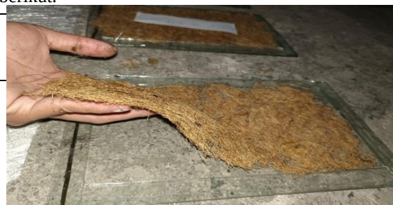
Gambar 2.3. proses pembuatan komposit menggunakan metode hand lay up
