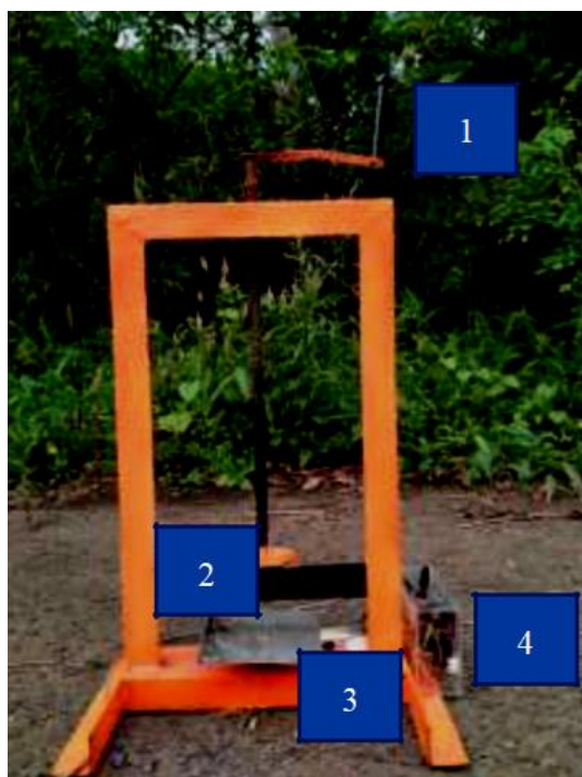
Gambar 5. Implementasi Alat uji (Keterangan: 1.penekan, 2.meja uji, 3. load cell , dan 4. Kotak berisi ( amplifier-kontroler-datalogger-lcd ))
