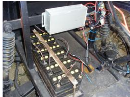
Gambar 7. Pemasangan accumulator di mobil listrik
