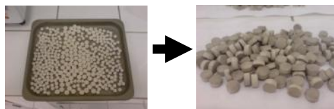
Gambar 2. Zeolit pelet perekat sebelum dan setelah diaktivasi fisik
