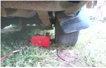
Gambar 12. Dongkrak belum mengangkat mobil gran max
