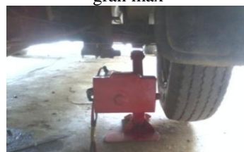
Gambar 11. Dongkrak telah mengangkat mobil pick up gran max
