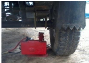
Gambar 14. Dongkrak belum mengangkat motor 3 roda
