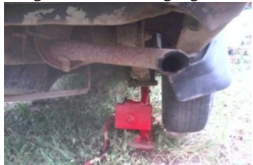
Gambar 13. Dongkrak telah mengangkat mobil gran max
