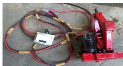
Gambar 9. Dongkrak ulir elektrik, saklar dan kabel
