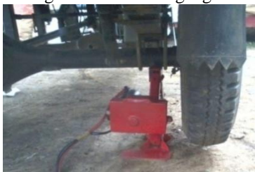
Gambar 15. Dongkrak belum mengangkat motor 3 rod
