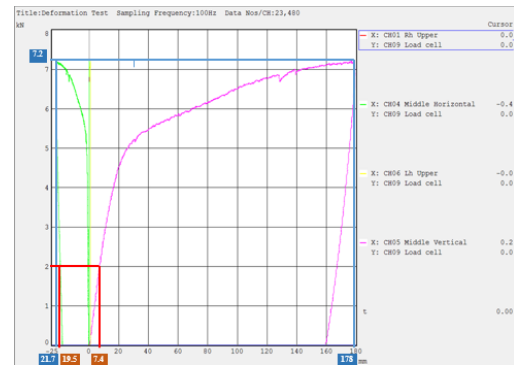
Gambar 4. Grafik hasil uji tekan current design
