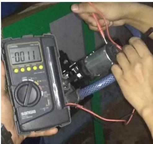
Gambar 10. Hasil pengukuran voltase pada sudut kemiringan turbin 35°
