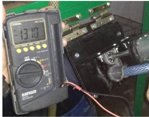
Gambar 11. Hasil pengukuran arus pada sudut kemiringan turbin 35°
