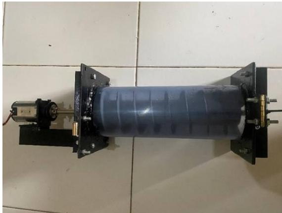
Gambar 7. Turbin *archimedes screw* yang telah dirakit
