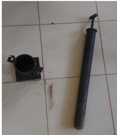
Gambar 1. Alat Uji Pemadatan Tanah *Modified Proctor Method*.
