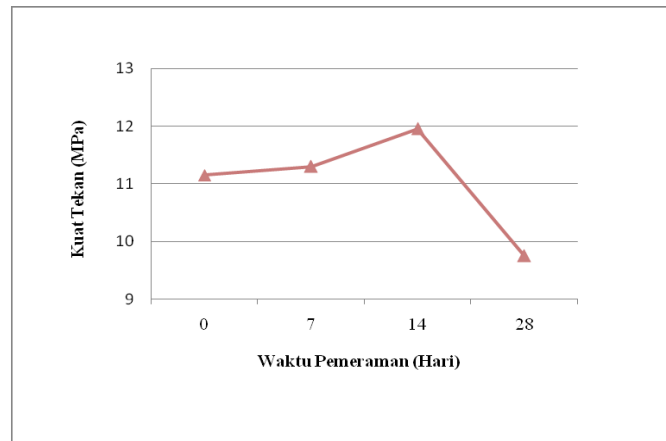
Gambar 3. Hubungan Antara Nilai Kuat Tekan Paving Block Pasca Pembakaran dengan Jangka Waktu Pemeraman
