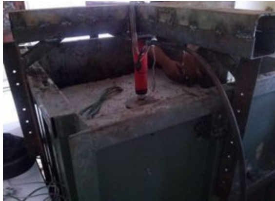
Gambar 5. Pemasangan matras beton bambu pada Kotak uji
