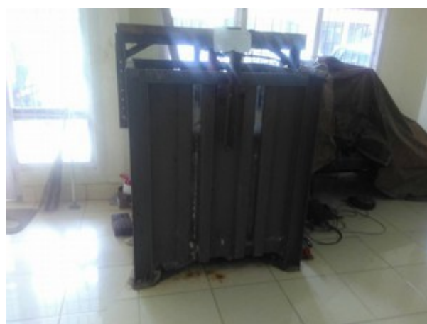
Gambar 1. Bentuk Kotak Uji Penurunan Tanah
