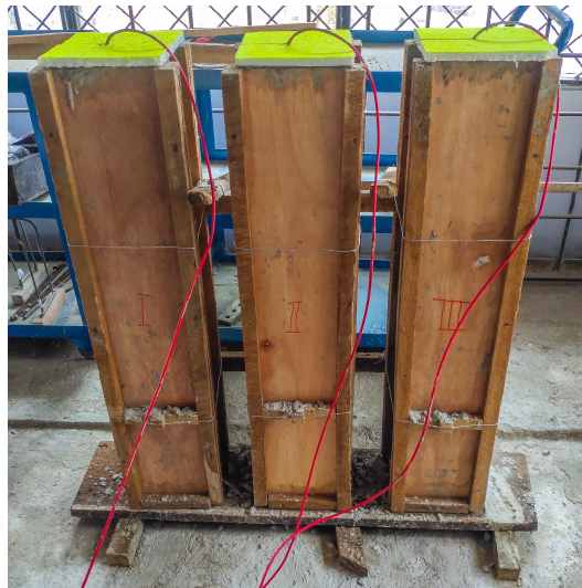
Gambar 3. Benda uji beton kolom (BK).
