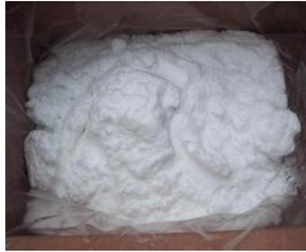
Gambar 1. Tanah Campuran Dengan Plastik
