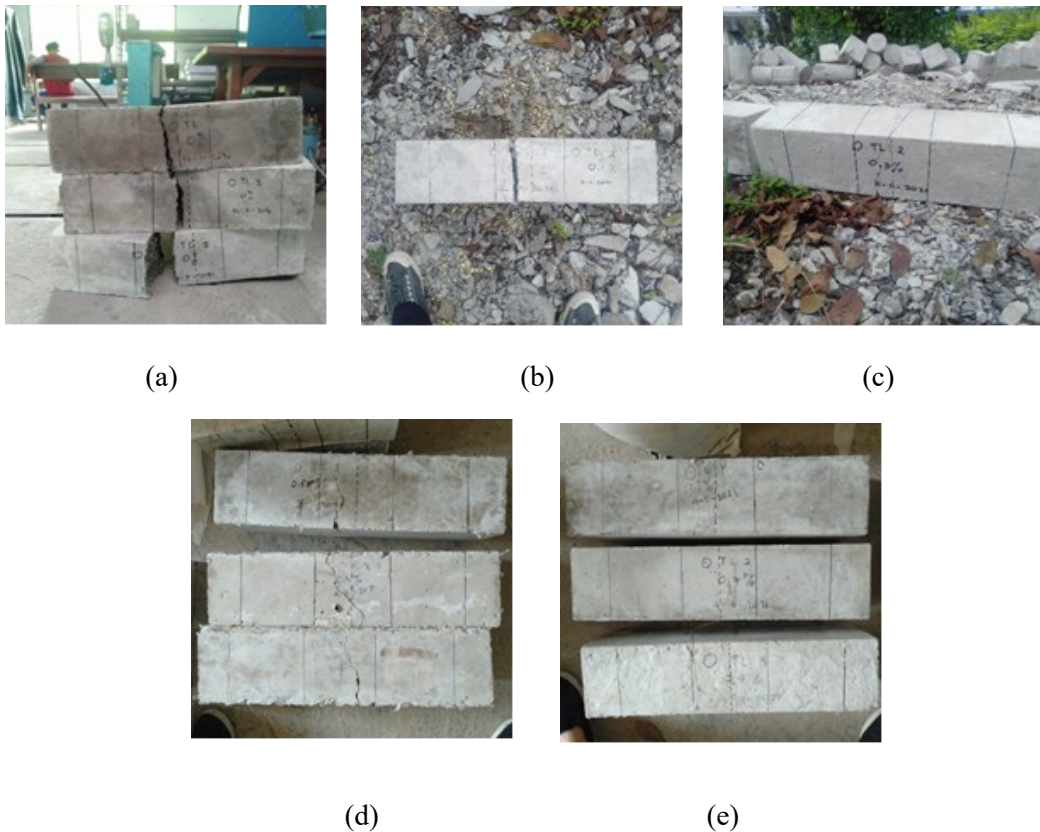
Gambar 7. Pola retak uji kuat tarik lentur dengan volume fraksi (a) 0%, (b) 0,1%, (c) 0,3%, (d) 0,5%, dan (e) 0,7%.
