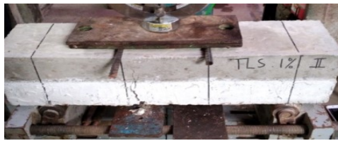
Gambar 6. Pengujian Kuat Lentur Balok Beton Serat Baja pada lapis Substrate .
