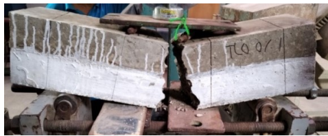
Gambar 5. Pengujian Kuat Lentur Balok Beton Tanpa Serat Baja.
