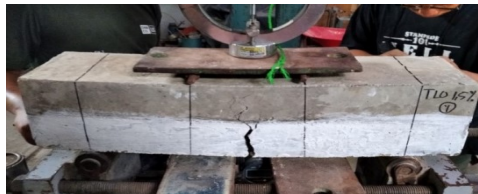
Gambar 7. Pengujian Kuat Lentur Balok Beton Serat Baja pada lapis Overlay .
