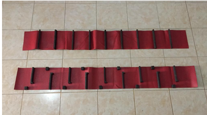
Gambar 2. Tipe pijakan tangga sekat dan vertical pool passes .
