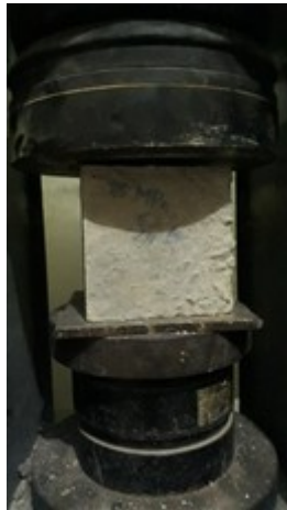
Gambar 6. Pengujian kuat tekan beton.
