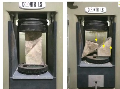
Gambar 4. Benda uji SST dengan variasi sudut 70^\circ (tanpa serat baja) : (a) sebelum diuji dan (b) setelah diuji.
